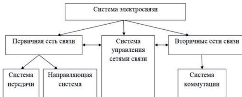
Рисунок 1. Структура системы электросвязи
