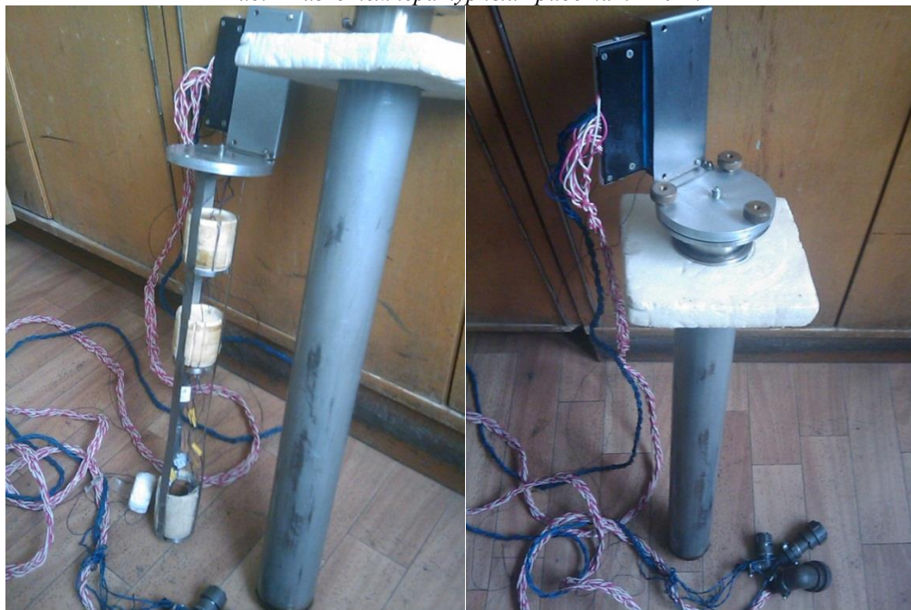
Рис.2 Низкотемпературный криостат КТЛТ.
