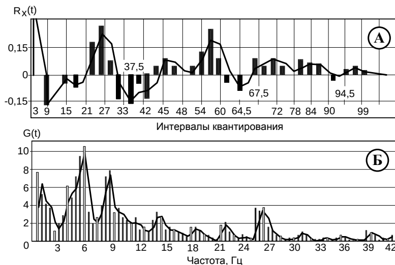
Рисунок 3 – Автокорреляционная функция биоэлектрической активности миоэлектрия КРС (А) и Спектральная плотность мощности процесса ЭГГ (Б).
