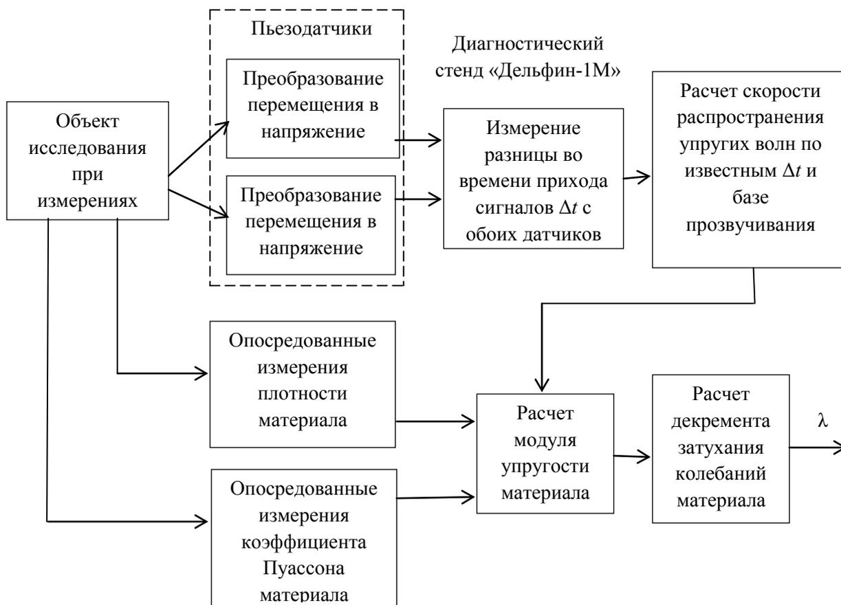
Рисунок 2 - Блок-схема преобразований измеряемой величины в акустическом методе измерения диссипативных свойств неметаллических гетерогенных материалов
