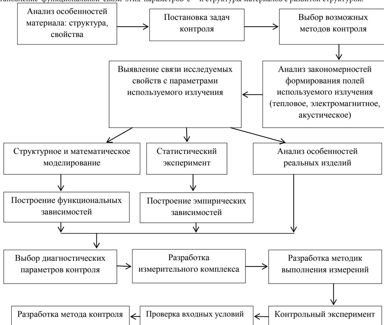
Рисунок 1 – Порядок разработки методов контроля свойств и структуры материалов с развитой структурой
