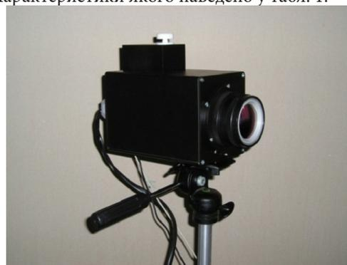
Рис. 1 Зовнішній вигляд термографа
