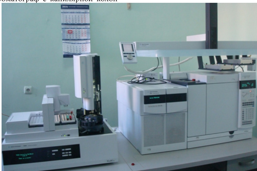
Рисунок 1 – газовый хроматомасспектрометр Agilent GC7890A 7000B с тремя квадраполями
