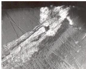
Рис.1. Микрофотография передней поверхности режущей пластины при обработке бронзы БрА5
