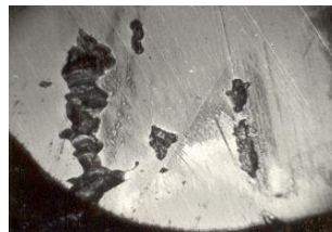
Рис.2. Микрофотография передней поверхности режущей пластины при обработке латуни ЛС59-1
