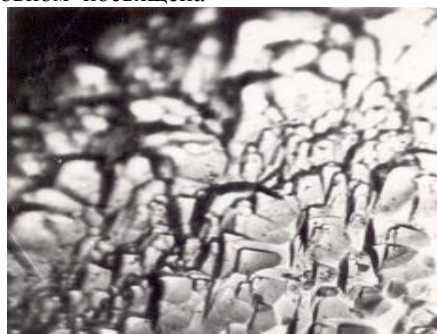
Рис.7. Следы дислокаций на поверхности скалывания режущей части пластины при \theta = 120^\circ (ув 300\times )
