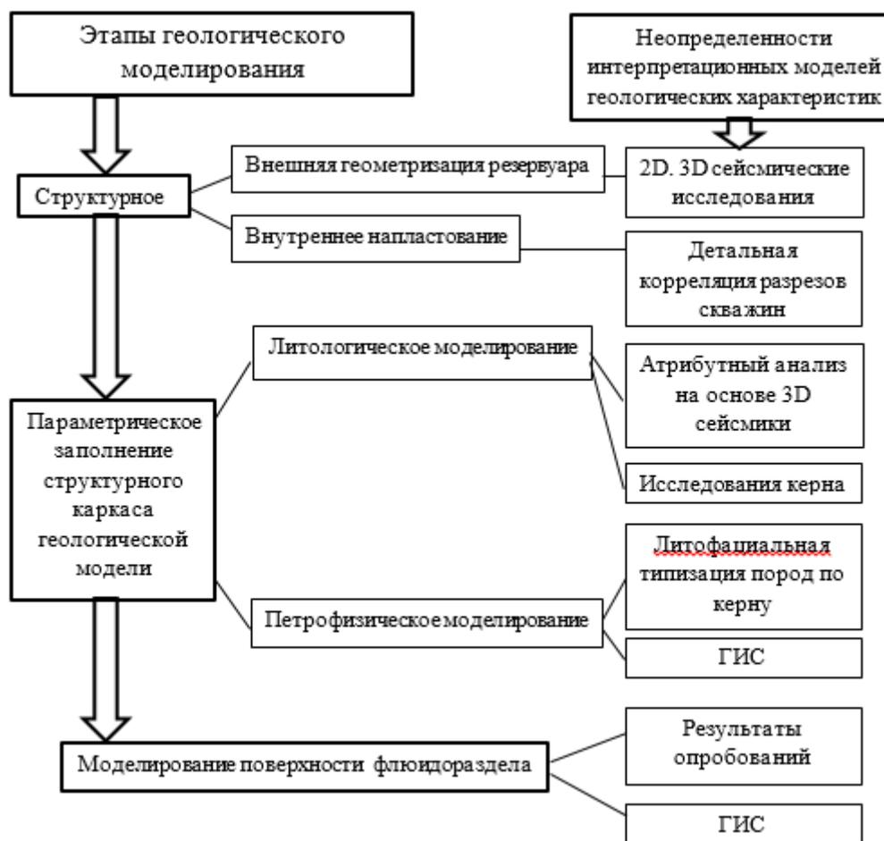
Рис. 1. Блок-схема соответствия этапов геологического моделирования и неопределенности интерпретационных моделей
