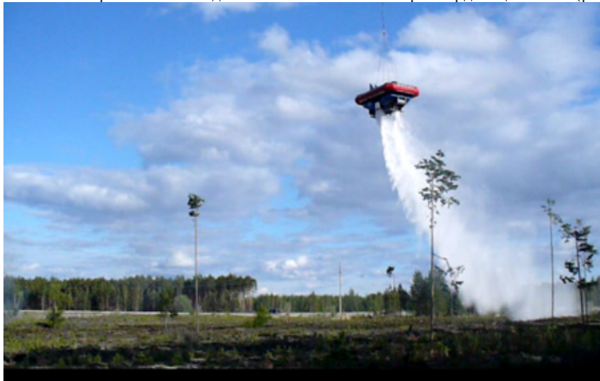
Рисунок 4.- Слив огнегасящей жидкости из ВВСУ УКТП ПУРГА.
