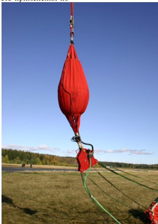
Рисунок 1. – Система дозированной подачи огнетушащих составов СДП-1.
