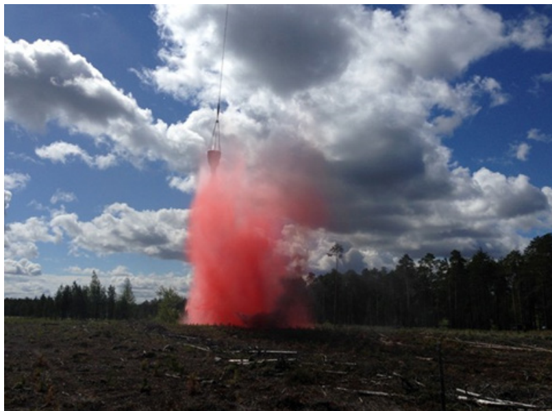
Рисунок 2.-Слив огнегасящей жидкости из ВСУ-5А с системой СДП-1 с использованием дистанционного управления. Технические характеристики системы СДП-1 приведены в таблице 1.
