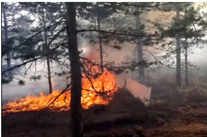
Рисунок 5.- Огнезащитный экран из кремнеземной ткани
