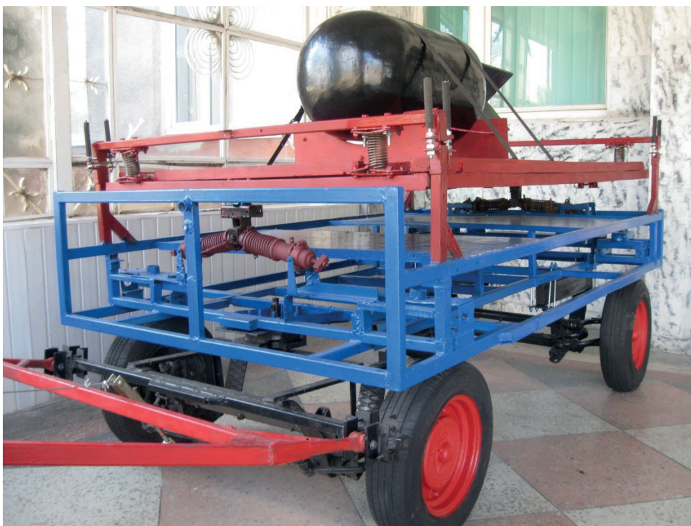
Рис. 1. Фотография опытного образца специализированного транспортного средства для перевозки взрывоопасных грузов
