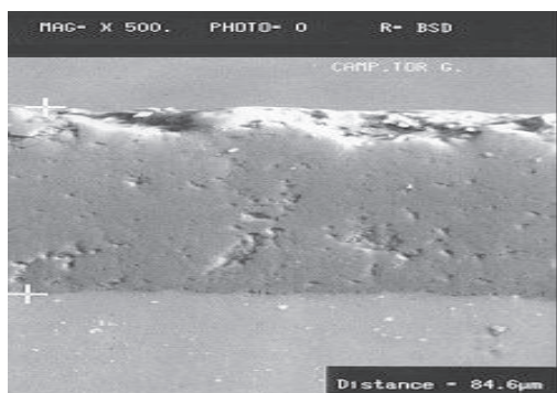
Рисунок 5. Динамика прироста толщины оксидных покрытий и структура, деформированных и литейных алюминиевых сплавов, полученная в идентичных условиях АМДО
