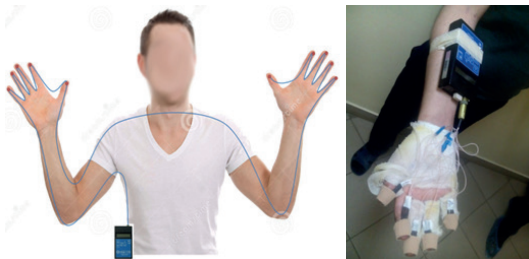
Рис.2 Схема установки датчиков на руке обмороженного человека.
