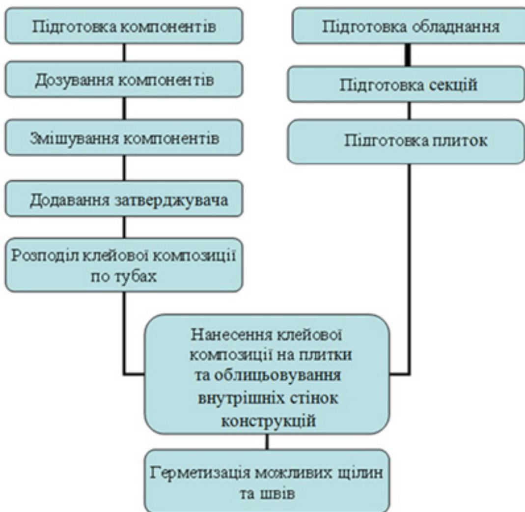
Рис. 3. Технологічна схема формування нероз’ємного з’єднання при виготовленні шаруватих конструкцій модульного типу
