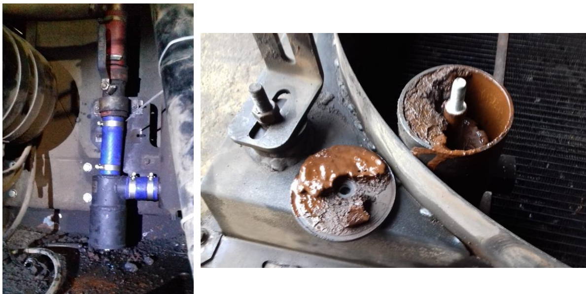
а) б) Рис. 6. Установка серийного образца ГФС на городском автобусе Волгабас (а) и внешний вид загрязнений в грязесборнике фильтра (б)
