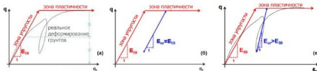
Рисунок 4. Идеально упруго-пластическая Модель Кулона-Мора [3].
