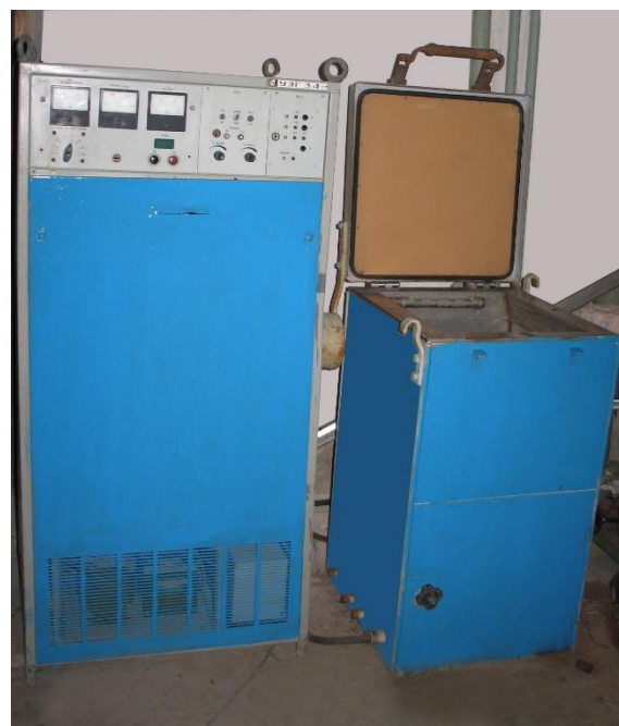
Рисунок 2 - Ультразвуковая ванна для очистки деталей
