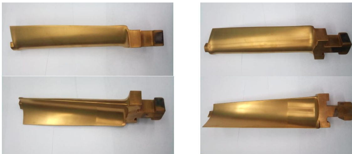
Рисунок 5 - Турбинные лопатки с нитрид титановым покрытием
