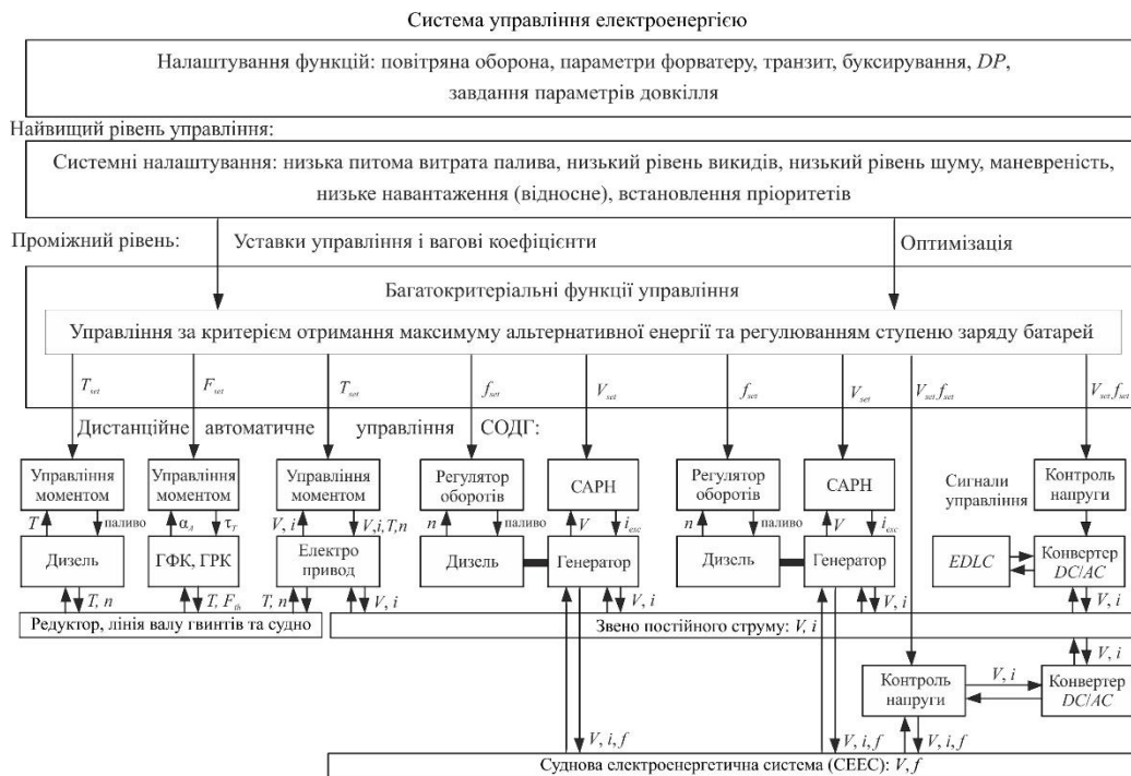
Рис. 3 Блок-схема стратегії управління СЕУ КПК за критерієм максимуму альтернативної енергії та регулювання ступеню заряду батарей СНЕ : САРН – система автоматичного регулювання напруги (англ. Automatic Voltage Regulator – AVR); X_{set} – уставка; T – упор (момент); F – сила поштовху гвинта; f – частота напруги; V – напруга; n – частота обертання СОДГ ; i_{exc} – струм збудження генераторів; i – струм; \tau_T – результуюча проекції вектору зусилля на площину руху судна; \alpha_A – кут повороту ПЦ відносно діаметральної площини судна
