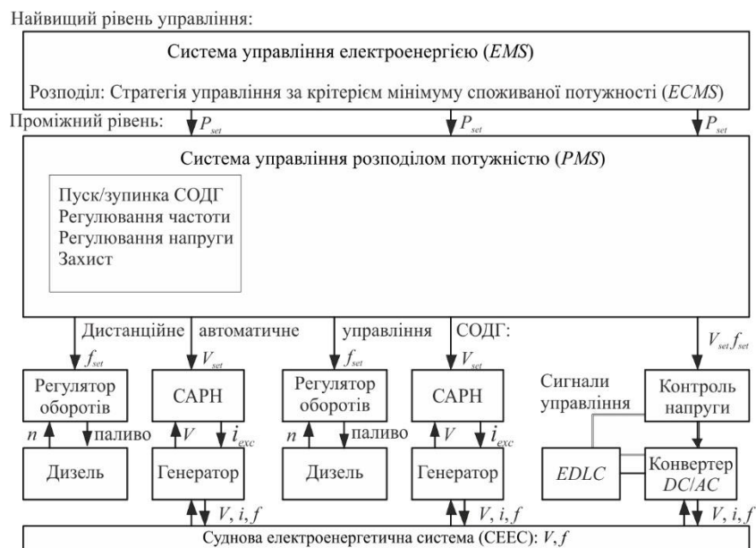
Рис. 2 Блок-схема управління гібридною СЕУ КПК за критерієм мінімуму споживання електроенергії: САРН – система автоматичного регулювання напруги (англ. Automatic Voltage Regulator – AVR); X_{set} – уставка; P – потужність; f – частота напруги; V – напруга; n – частота обертання СОДГ; i_{exc} – струм збудження генераторів; I – струм СОДГ.
