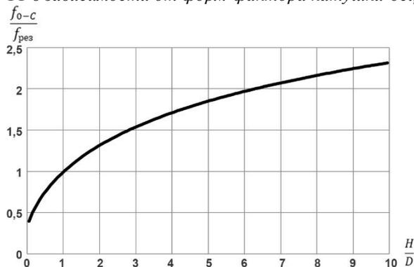
Из графика видно, что при  $\alpha = \frac{H}{D} \approx 1,06782 \frac{f_{0-c}}{f_{рез}} = 1$ . Т.е. график 4 ещё раз подтверждает, что при таком форм-факторе частота собственного резонанса катушки-осциллятора совпадает с частотой резонанса РТТ.
