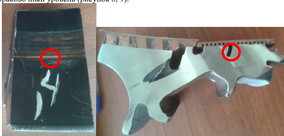
Рисунок 8 – Расположение выявленных отражателей в образце №2
