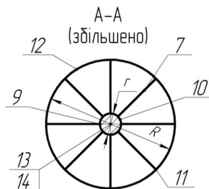
Рис. 2. Поперечний переріз в поздовжньому перерізі нижнього торця центрального електроду
