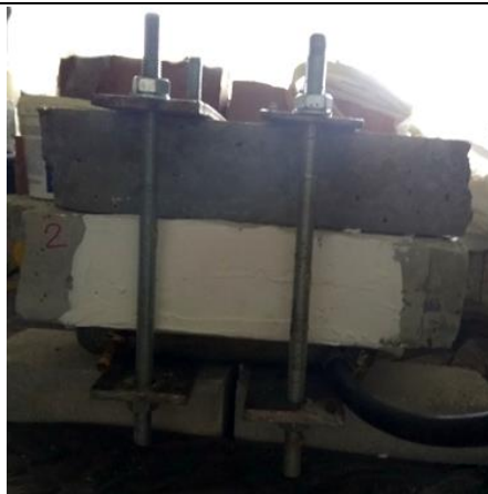
Рисунок 3. Просочення залізобетонного зразка за допомогою «лоточка»
