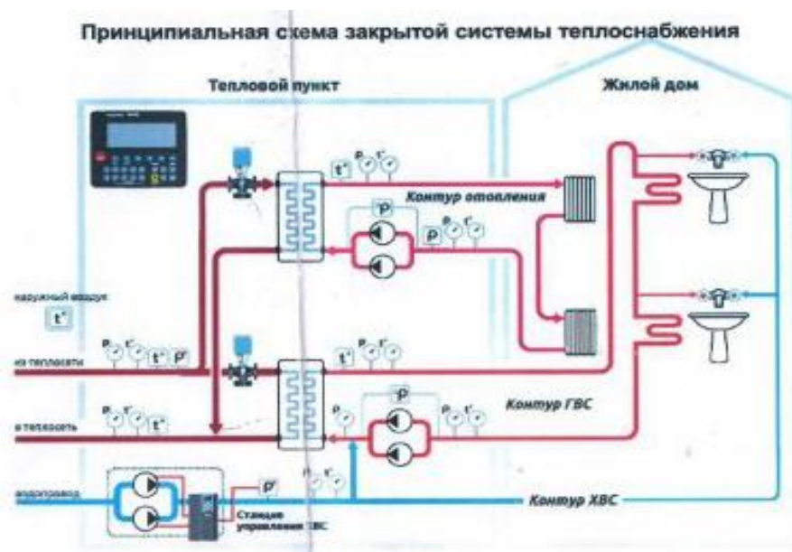
Рис. Предлагаемая система закрытого присоединения ГВС и независимой системы отопления
