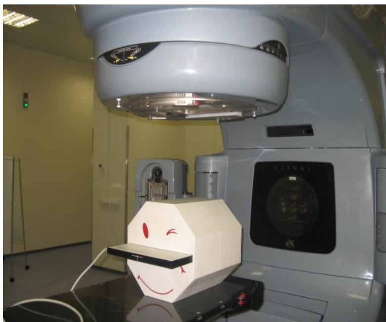
Рис.1. Фантом Octavius на столе ускорителя электронов Clinac iX.
