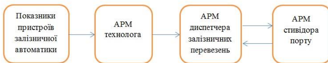
Рис. 1. Структурна схема координаційної взаємодії диспетчерських служб припортової залізниці
