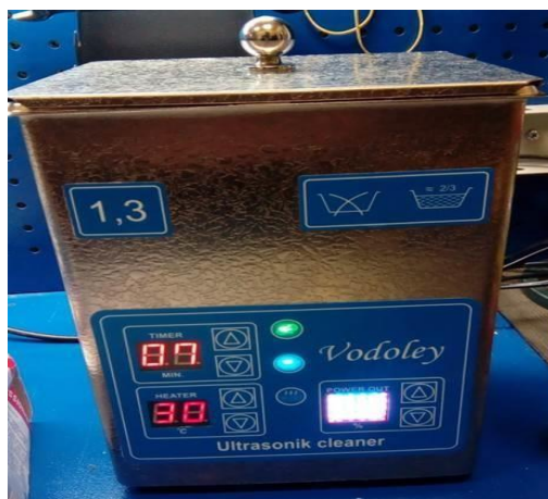
Рис. 3. Зовнішній вигляд ультразвукової ванни, що використовувалася для очищення
