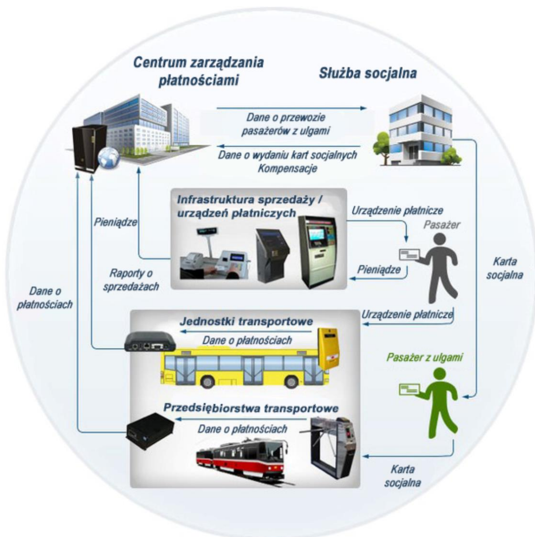
Rys. 2. Zautomatyzowany system płatności za przejazd CS-Trans [36]
