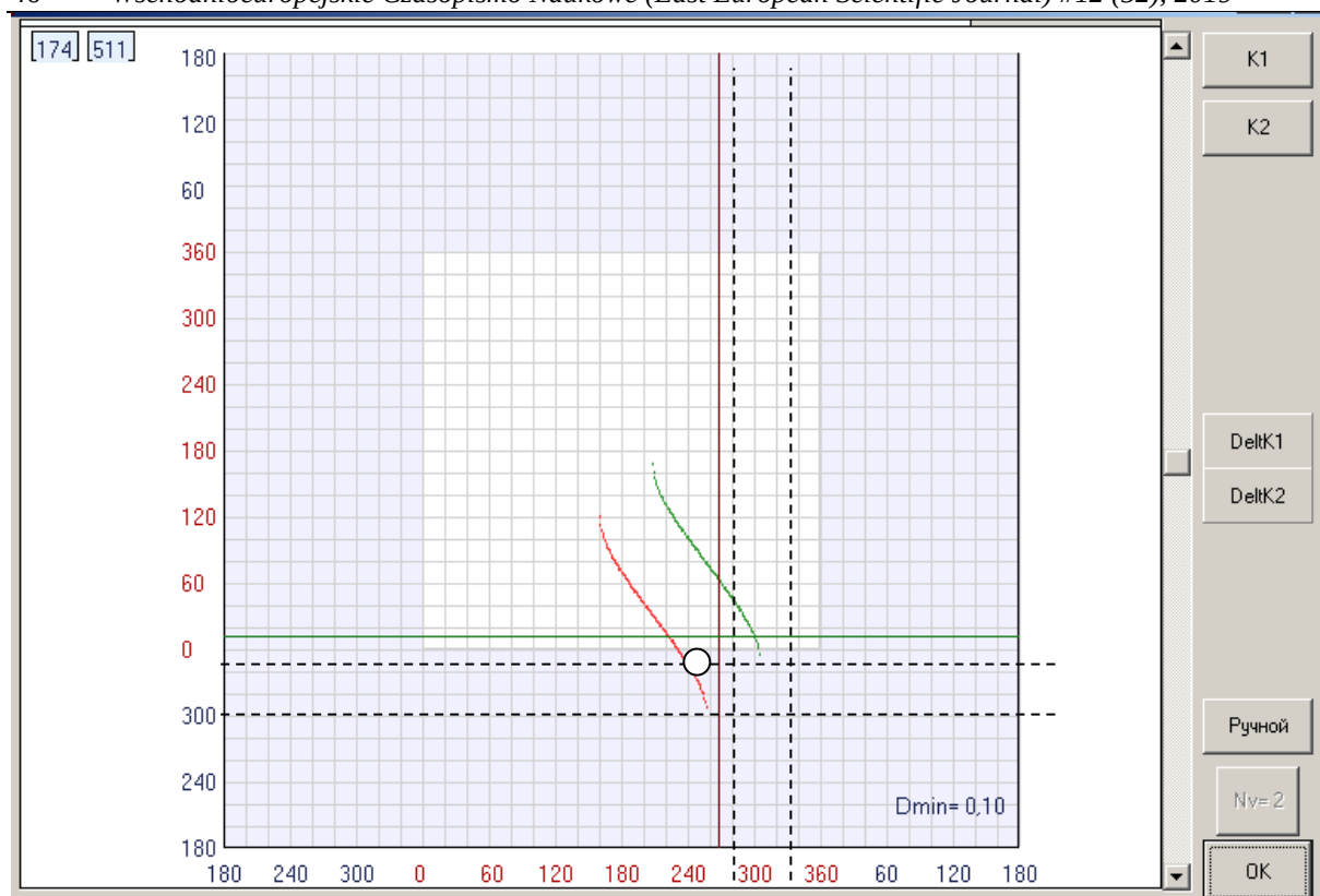
Рис. 6. Область опасных курсов S_{Dij} с учетом линейной опасности
