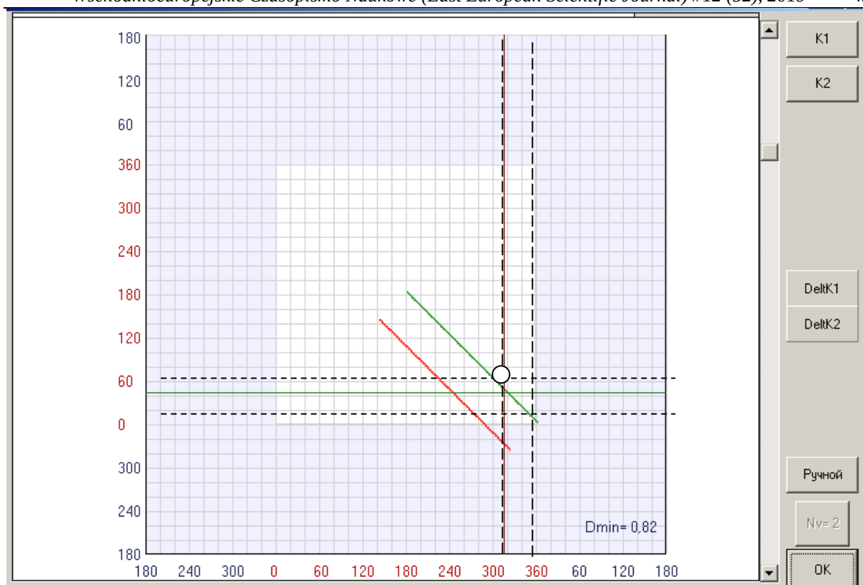
Рис. 2. Область опасных курсов S_{Dij} с учетом точечной опасности
