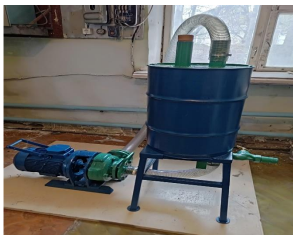
Рис.1. Представлена конструкция изготовленного экспериментального образца кавитатора-измельчителя.
