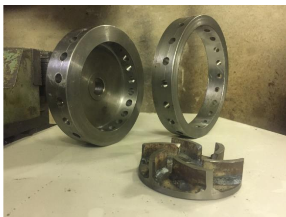
Рис.2. Основные детали кавитатора: крыльчатка, ротор и статор (где позиции и названия деталей).
