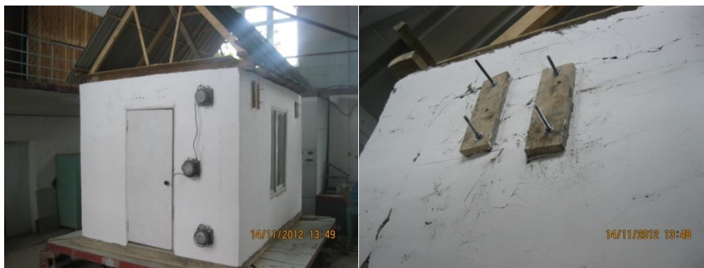
Рис. 6. Общий вид модели дома из “железобетонного каркаса”, после эксперимента
