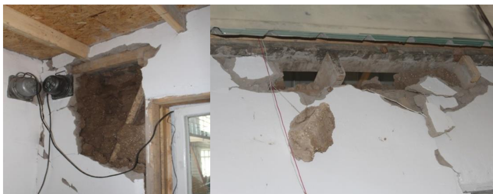
Рис. 4. Общий вид модели дома типа “сынч”, после эксперимента
