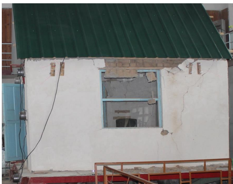
Рис. 2. Общий вид модели дома, из кирпича-сырца, после эксперимента
