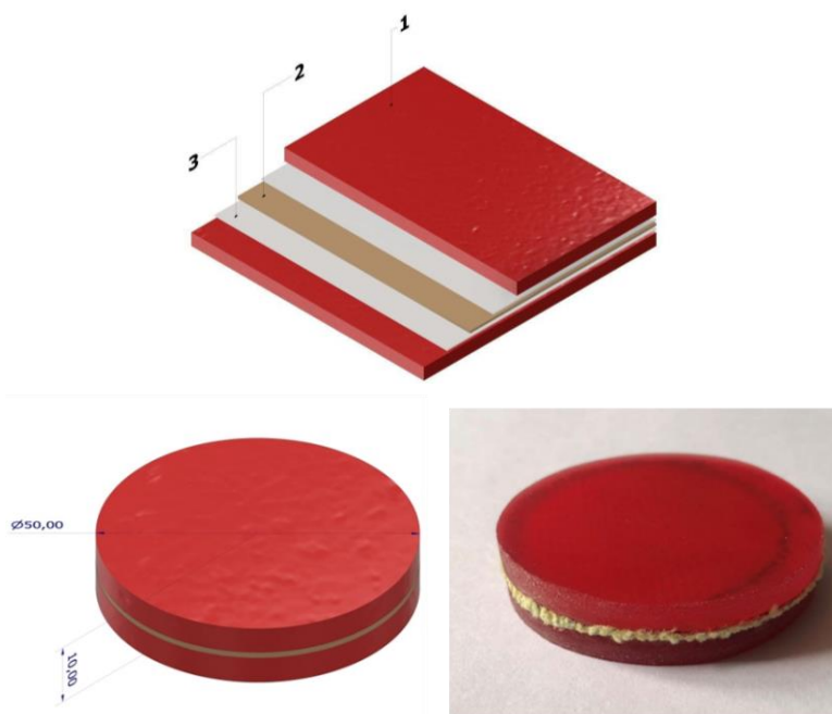
Рисунок 1 – Структура композиционного материала 1 – матрица, 2 –кевлар, 3 –связующее (циакрин)
