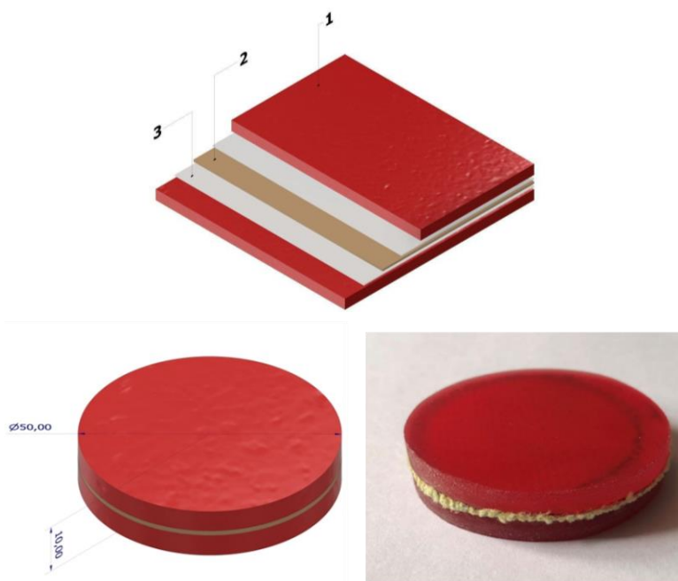
Рисунок 1 – Структура композиционного материала 1 – матрица, 2 –кевлар, 3 – связующее (циакрин)
