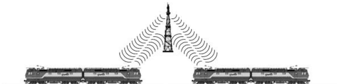
Рисунок 3 - Виртуальная сцепка с обменом данными через радиоблок-центр
