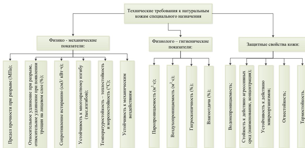
Рисунок 1 – Требования к характеристикам натуральных кож, применяемых для изготовления специальной одежды и обуви
