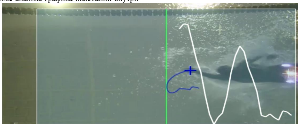
Рисунок 1. Пример кадра подводной видеосъемки с наложенным графиком внутрицикловой скорости и кинематической структуры выполнения гребка одной рукой. Вертикальная линия в центре графика указывает точку на графике, которая соответствует данному кадру.
