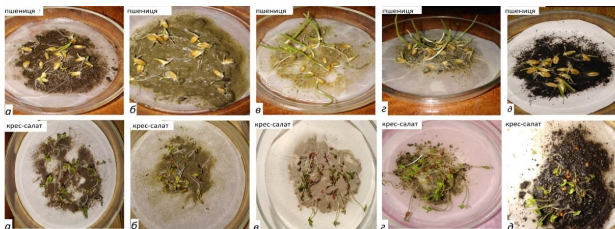
Рисунок 1 – Пророщування крес-салату та пшениці на 96 годину досліду (а, б, в – проби ґрунту на відстані відповідно 800 м, 500 м, 200м; г – проба гірничої маси безпосередньо з відвалу; д – контрольна проба ґрунту)
