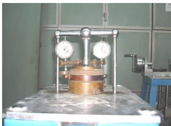
Рис.1. Внешний вид и схема прибора для определения структурной прочности 1 - направляющее кольцо; 2 - штамп; 3 - образец грунта; 4 - корпус; 5 - индикатор часового типа; 6 - нижнее кольцо; 7 - верхнее кольцо
