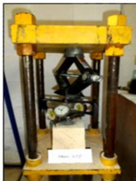
Рис. 2. Схема и внешний вид силовой установки для испытания известняка-ракушечника моделями буронабивных свай 1, 2 - неподвижные плиты; 3 - образец известняка; 4 - модель свай; 5 - динамометр; 6 - индикаторы часового типа; 7 - домкрат; 8 - полость под пятой свай
