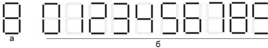
Рис. 1. Семисегментный формат индикатора (а) и цифровые знаки на его основе (б).
