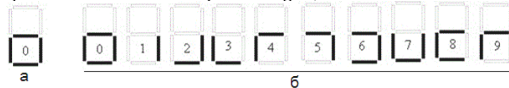
Рис. 3. Четырехсегментный формат (а) и цифровые знаки на его основе (б).
