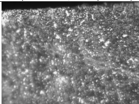
Рисунок 2 – Структура стали P6M5 после МПО Figure 2 – The structure of steel P6M5 after magnetic pulse processing
