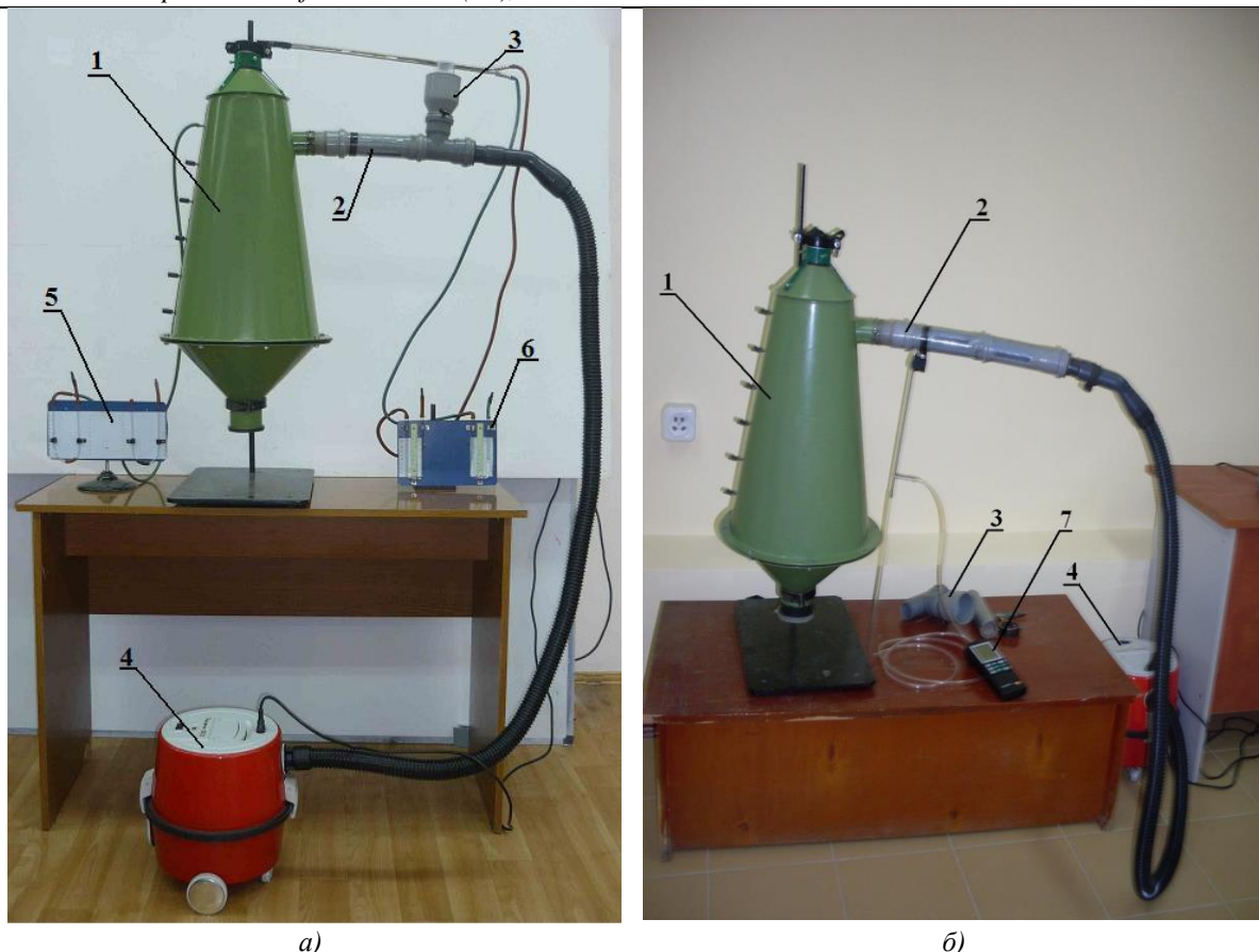
Рис. 16. Экспериментальная установка: а – с жидкостными манометрами, б – с манометрами Testo 521 (Германия)
