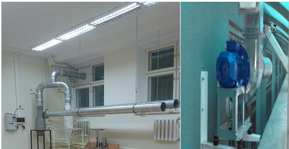
Рис. 5. Экспериментальная установка: 1 – «Циклон ЦН15у-300», 2 – «ЦОК-200-300», 3 – входной патрубок «Циклон ЦН-15у-300», 4 – входной патрубок «ЦОК-200-300», 5 – регулируемая перегородка, 6 – патрубок выходной, 7 – вентилятор радиальный, 8 – блок управления вентилятором (электронный)
