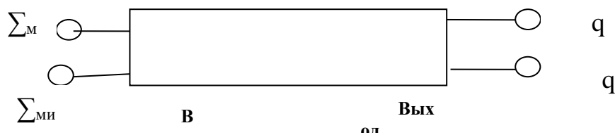
Рис. 6. Схема однородной линии (с потерями) как «обобщенный трансформатор» [8]
