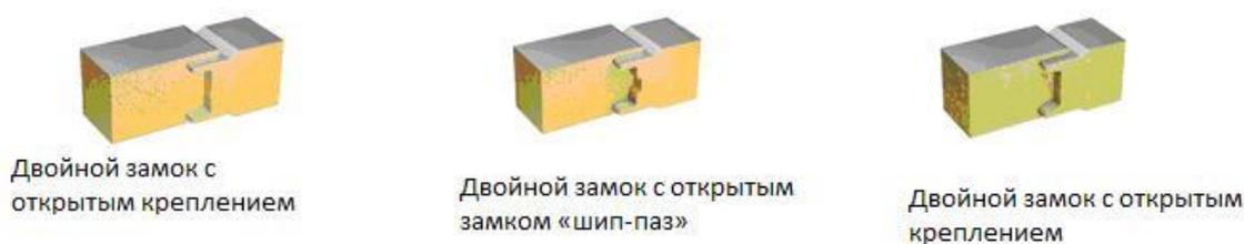
Рисунок 1 - Общий вид вариантов крепления типа «шип-паз» сэндвич-панелей
