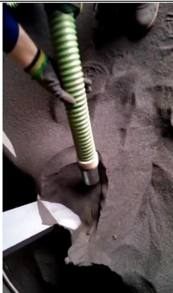
Рис.6 Уборка угольной пыли, пылесосом, на тепловых электростанциях.
