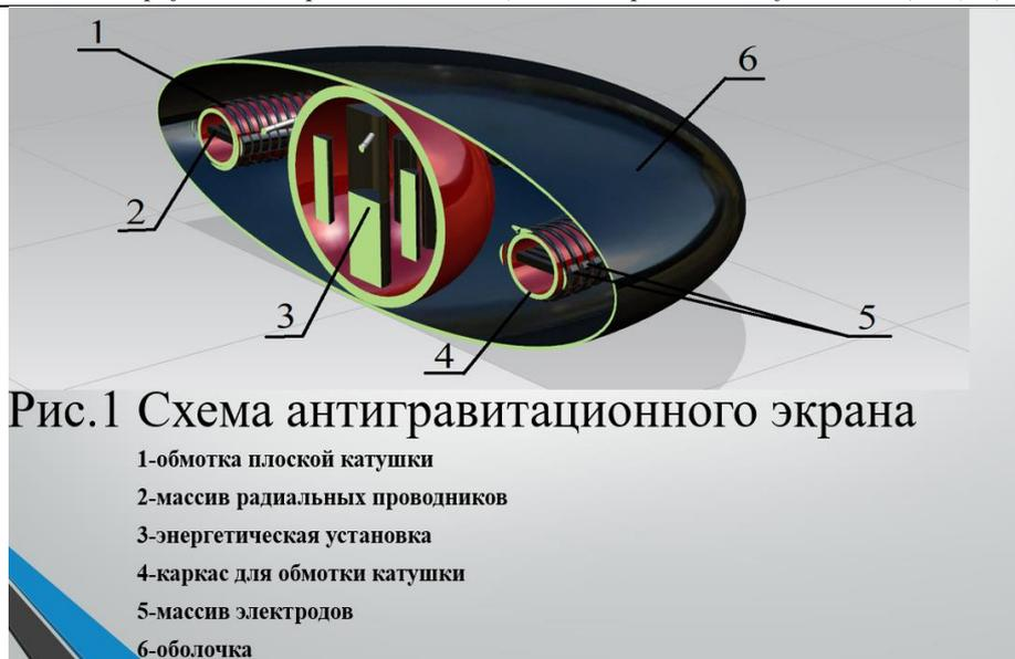
На рис. 1 представлена принципиальная схема устройства. Оно состоит из плоской кольцевой индукционной катушки-1 и системой радиальных проводников пересекающих плоскость симметрии катушки-2, встроенное в каркас-4
