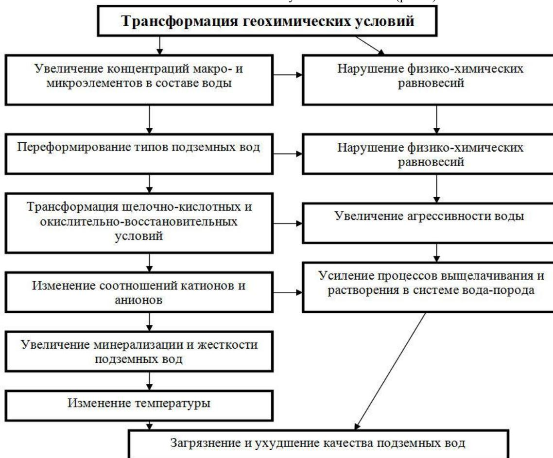
Рис. 2. Характер трансформации гидрогеохимических условий при эксплуатации водоносных горизонтов
