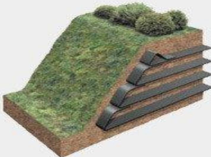
Рис. 5. Склон, укрепленный с помощью геотекстиля.
