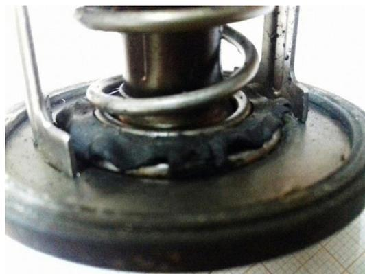
Рис.3. Клапан термостата с разрушившимся уплотнительным резиновым элементом
