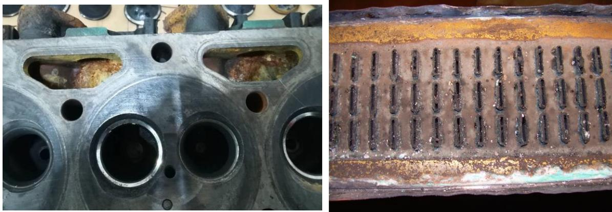
Рис. 1. Коррозионные отложения на элементах СЖО
