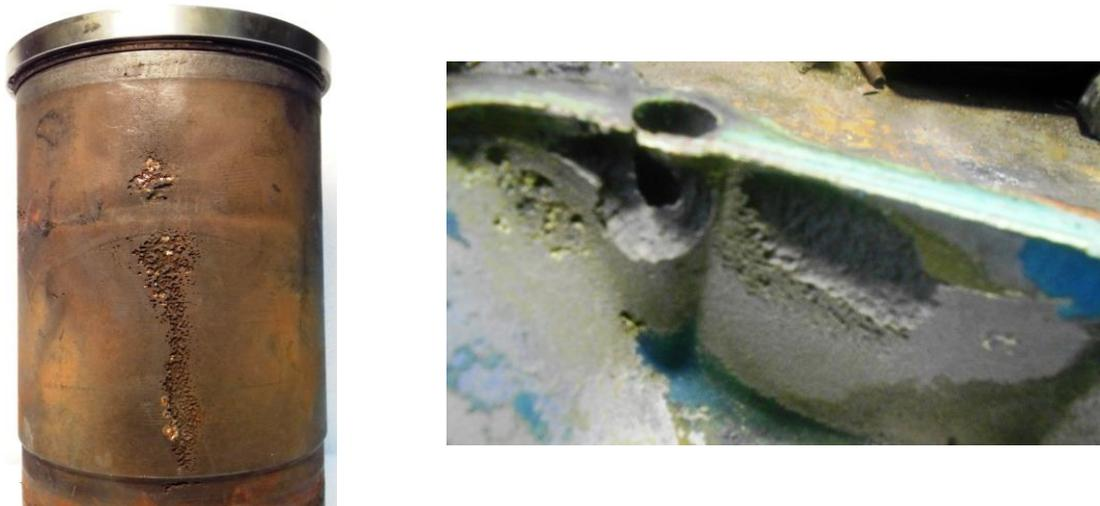
Рис. 2. Последствия кавитационной эрозии в элементах СЖО
