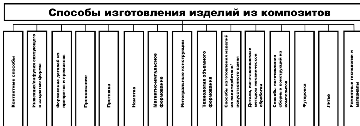
Рис. 1. Основные способы получения изделий из ПКМ.
