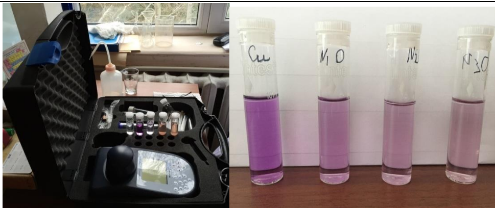
Рис.1. Определение содержание меди фотометрическим методом на приборе
