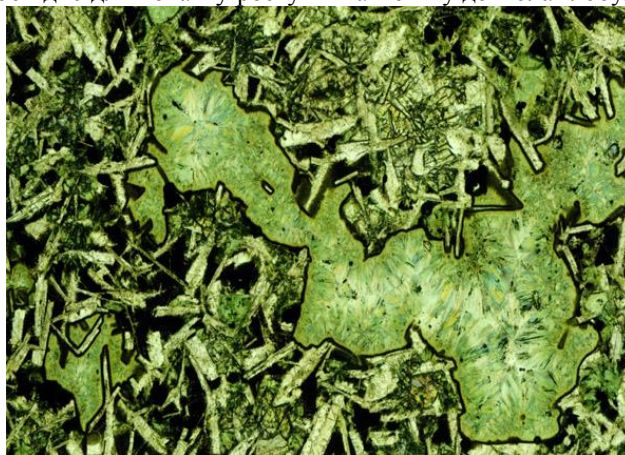
Рис. 3. Характер кристалізації мінеральної речовини (від зони відтоку тепла у напрямку центральної частини) і характерна особливість – утворення дифузної оболонки магнетиту довкола глобулі. Заболотівська світа. Св. 4583. Глибина 215,0 м. Ширина поля зору 3,5 мм. Ніколі ІІ.
