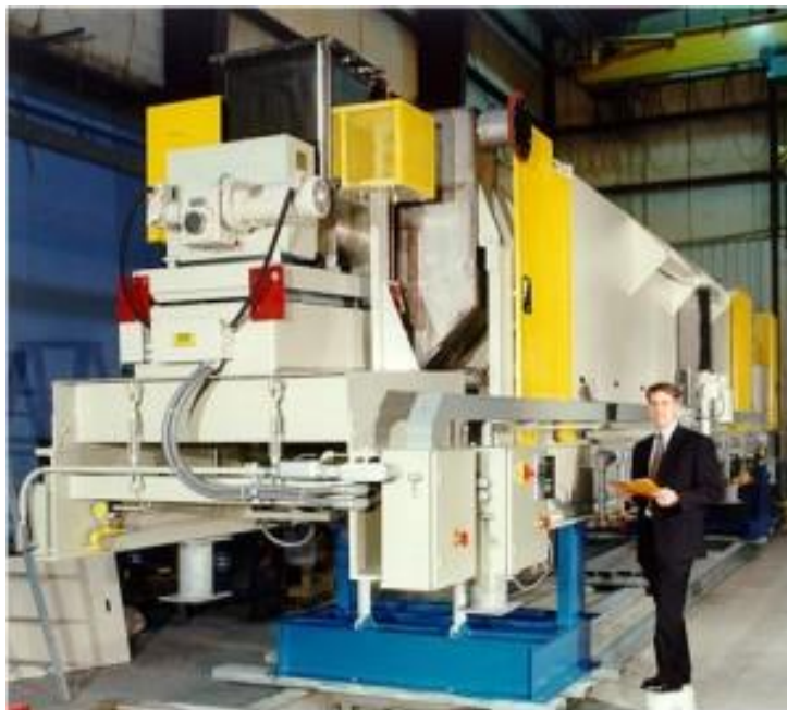
Рис. 1. Изображение вращающиеся печи «Harper».
