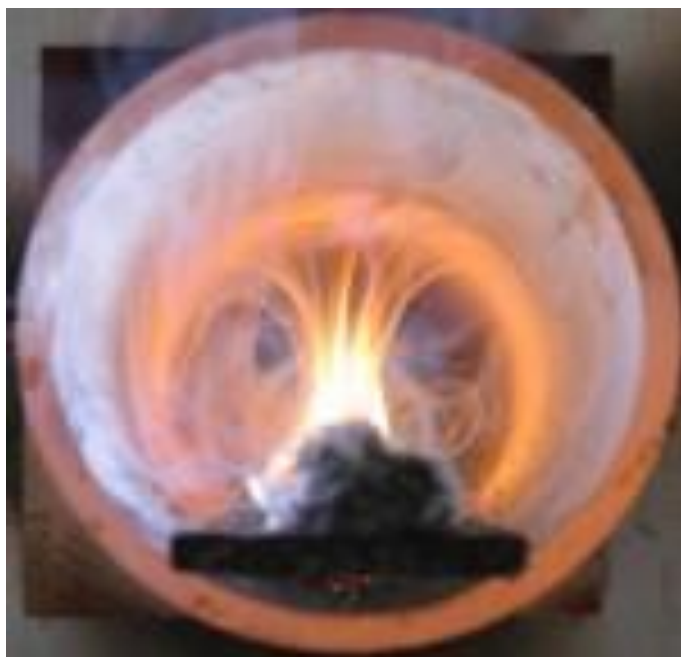
Рис. 2. Процесс обжига руды в печи «Harper».
